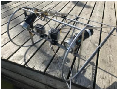
Figur 1 Kameraslåde med två GoPro-kameror och undervattenslampor designad av A.Emanuelsson
